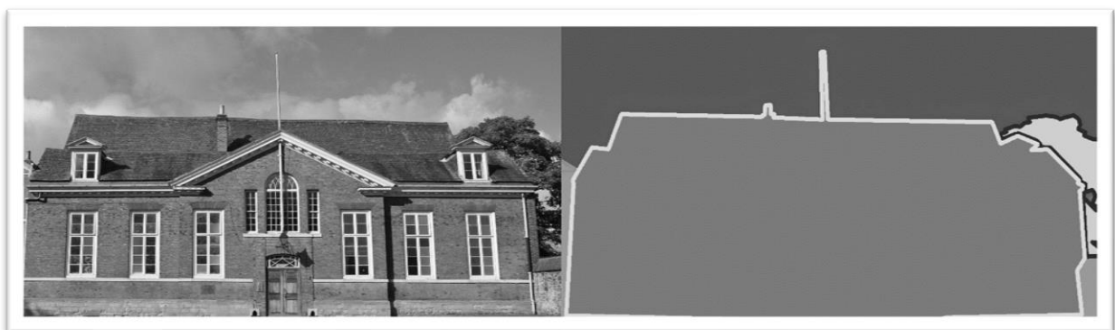
Abbildung 2: Ein originales Einzelbild und die entstandene Maske, die von einem Segmentierungsalgorithmus generiert werden.
